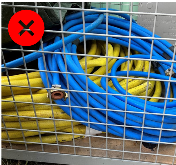
Abbildung 5: Unzulässige Lagerung von Trinkwasser- und Abwasserschläuchen
