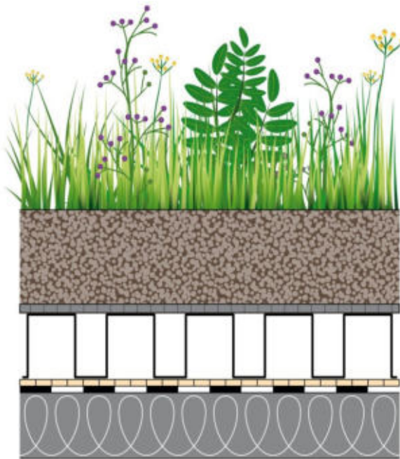
Gründach-Aufbau in mehrschichtiger Bauweise
