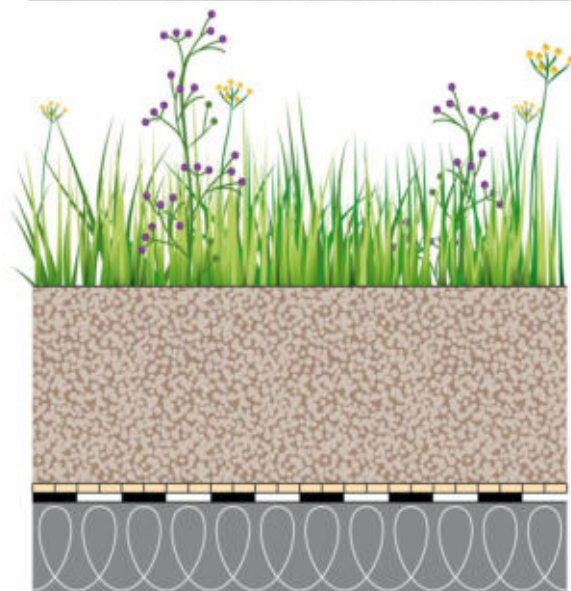
Gründach-Aufbau in einschichtiger Bauweise
